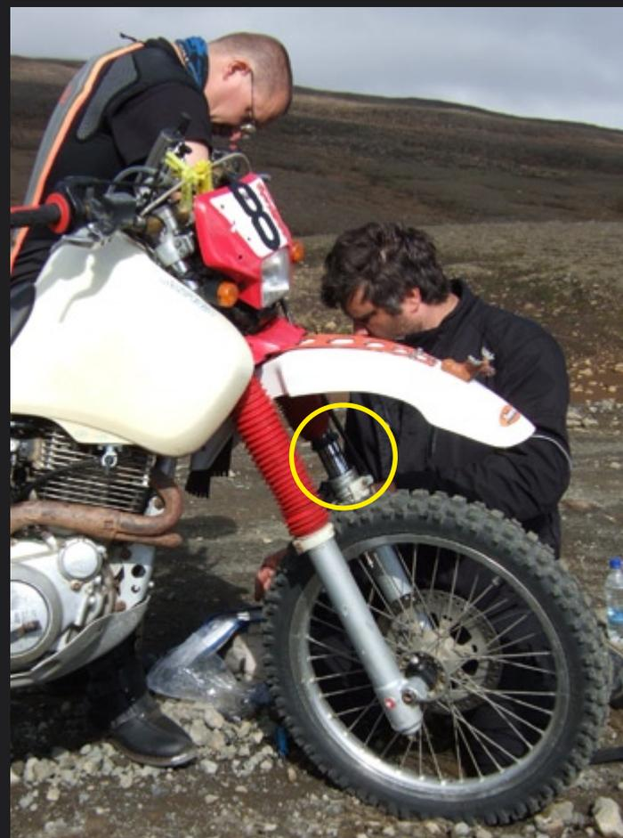
*Während eines Foto-Stopp, um die ersten Ausläufer des Langjökull-Gletscher abzulichten, entdecken wir am linken Gabelholm Rappels TT Ölsuren. Der Gabel-Simmering drückt ab, kann aber notdürftig repariert werden.*
